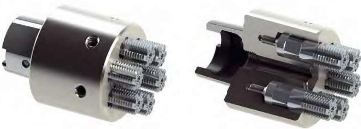
Spezieller Glockengewindefräser für den Einsatz in der Massenfertigung. Aufgrund der ausgeklügelten Konstruktion kann jeder Wechselfräseinsatz bis zu sechs Schneiden zur Verfügung stellen. Dadurch können mit diesem Werkzeug hervorragende Standmengen realisiert werden.
